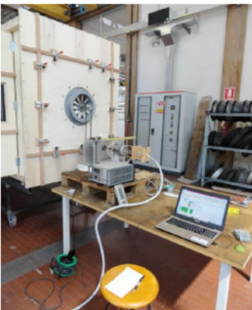
*La galleria permette di effettuare prove su macchine di dimensioni differenti. Nell'immagine, un ventilatore di 315 mm in prova.*
