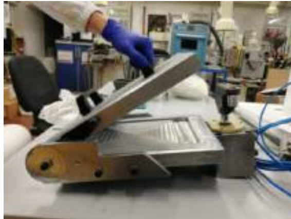
Figura 1 - Stampo utilizzato per la produzione dei campioni
