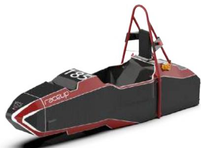
La rigidezza della monoposto e soprattutto la sicurezza del pilota sono garantite dalla monoscocca in fibra di carbonio che abbiamo sviluppato, che nel contempo, grazie al peso molto ridotto (23 Kg) permette di raggiungere alti livelli di performance.
